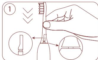
Аккуратно наденьте насадку на посадочное место. Оставьте небольшой зазор между насадкой и корпусом, зазор необходим для того, чтобы щетка могла вибрировать.
