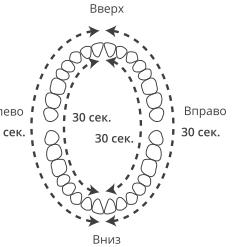
Для обеспечения равномерного очищения разделите полость рта на четыре равных условных зоны и очищайте их поочередно. Встроенный таймер уведомит вас о смене зоны чистки коротким прерыванием колебаний щетины после 30 секунд работы. После четырех 30-секундных интервалов щетка отключится автоматически.
